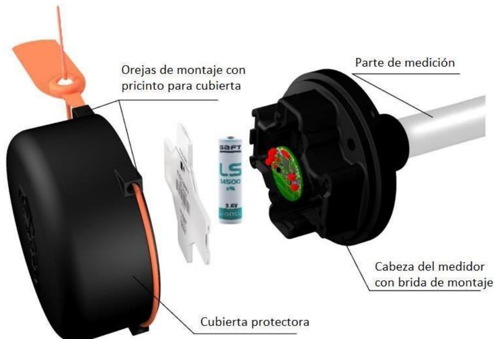
Figura. 3.1. Construcción del sensor de nivel de combustible TD-BLE
