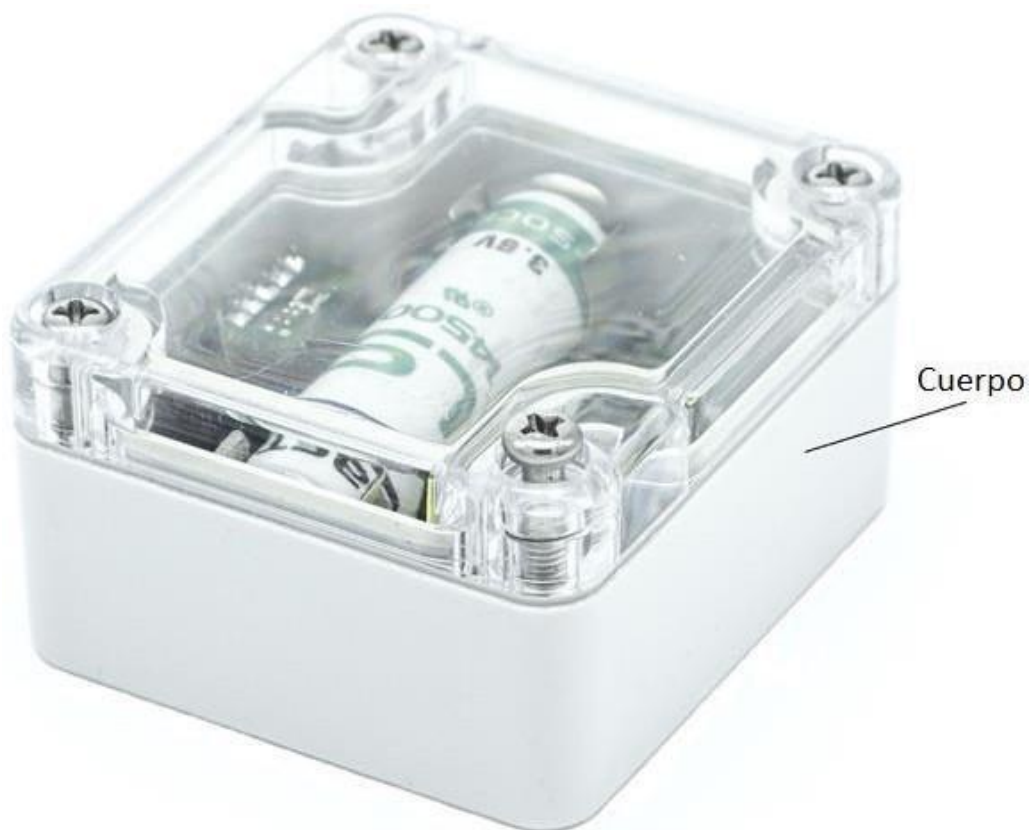
Figura.3.4. Construcción del sensor inalámbrico de temperatura e iluminación TL-BLE.
