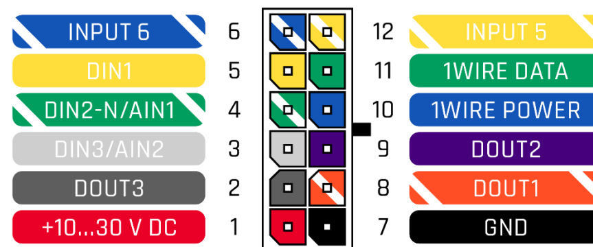
Figura 2 Patillaje de la toma de 2x6 del FMU130
